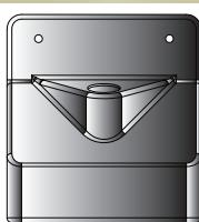
**Position 1** ist gemeint für geringe Pumpenleistung. Die maximale Länge der Trennwand sorgt dafür das der Wasserniveau unter dem Sieb nicht zu hoch ansteigt wodurch das Sieb unter Wasser steht bei relativ geringe Pumpenleistung.
